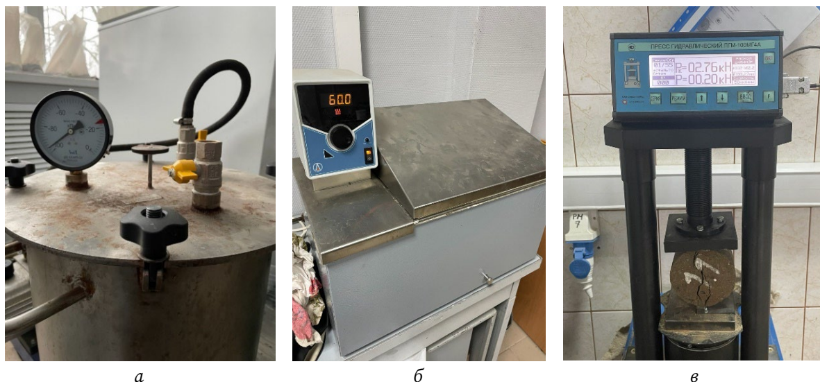
Рис. 1. Процесс испытания опытных образцов: а – водонасыщение; б – термостатирование; в – испытание на гидравлическом прессе
