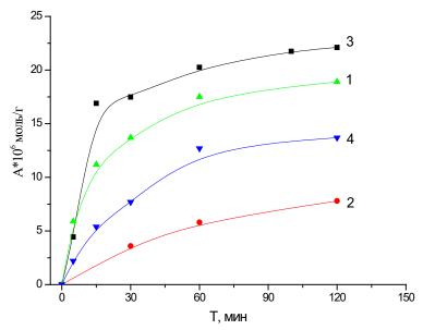
**Рис. 2**. Кривые сорбции тетрациклина. 1. – активированный уголь; 2. - бентонит, 3 – уголь : бентонит = 30 : 70; 4 – уголь : бентонит = 50 : 50.
