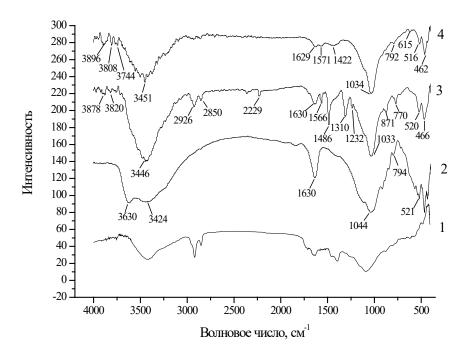
**Рис. 1**. ИК-спектры: 1. – активированный уголь; 2. - бентонит, 3 – уголь : бентонит = 30:70; 4 – уголь : бентонит = 50:50. Время механоактивации 15 минут.
