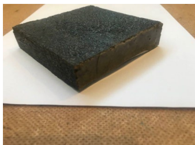
Рис. 2. Образец из полимербетона ВЕТОFLEX холодного отверждения Fig. 2. BETOFLEX cold-cured polymer concrete sample
