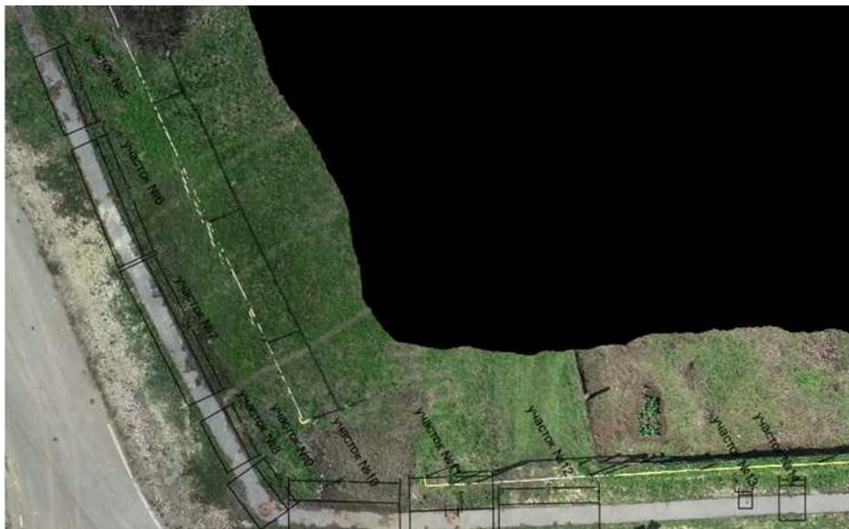
Рис. 4. Фрагмент плана тротуара с выделенными разрушенными участками
