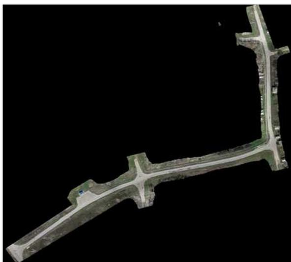
**Рис. 1.** Ортофотоплан дороги с привязкой к характерным опорным точкам
