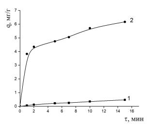
**Рис. 1.** Кинетика сорбции ионов Cu (II) из водных растворов льняным волокном: 1 – немодифицированным; 2 – модифицированным L-аргинином
