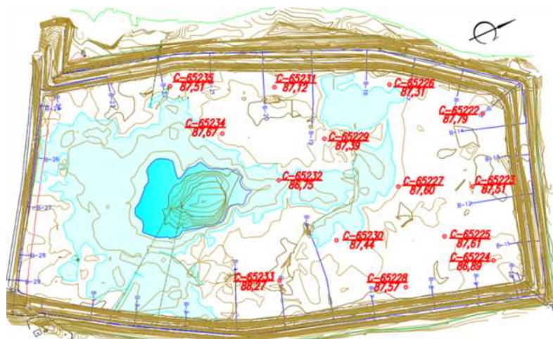
Рис. 2. Схема отбора проб на секции № 2 отвала СП ТЭЦ-4 АО «ТГК-11»
