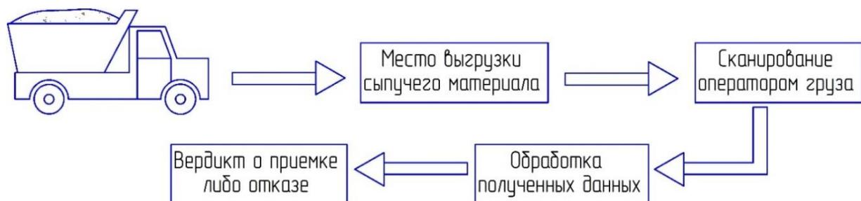
Рис. 3. Принцип действия устройства
