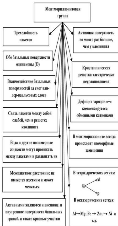
Рис. 3. Особенности состава и структуры минералов группы монтморилюнита [17]
